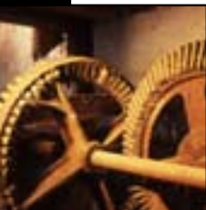
Ingranaggi per la trasmissione del moto dell'Antico Mulino Riseria San Giovanni Piemonte Parchi
