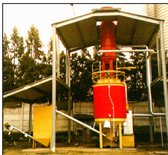
Gasogeno: vista e schema (da "Recupero di Energia da Biomassa" – P.Caputo, A.Romer)
