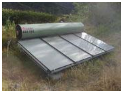
Figura 4.3.17 – Collettore piano vetrato con serbatoio di accumulo
