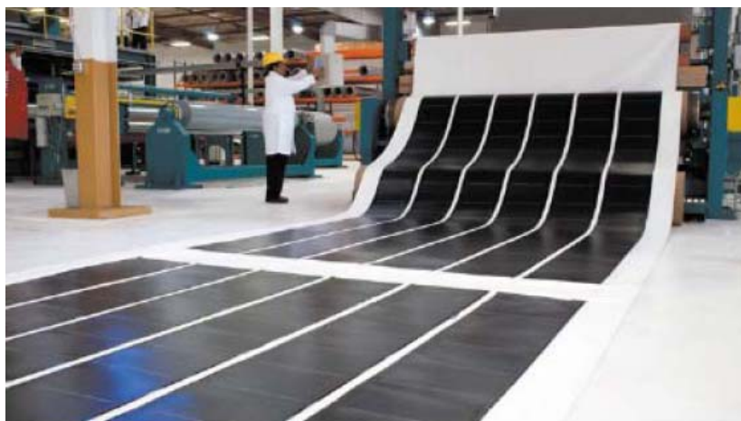
Figura 4.2.5 – Produzione di pannelli a film sottile su supporto flessibile
