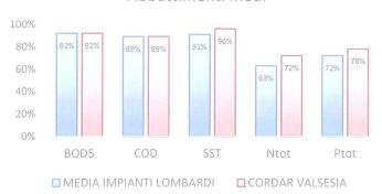
I risultati registrati per l'anno in esame si possono ritenere soddisfacenti: oltre all'ampio margine rispetto alle indicazioni normative per i parametri BODs, COD e solidi sospesi totali, si registra, per tutti i parametri in esame, un abbattimento in linea con la media degli impianti presi a confronto, con picchi decisamente superiori alla media per solidi sospesi totali e nutrienti.
