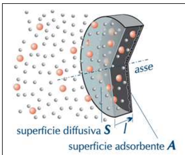
Figura 2 – Principio operativo di campionatore diffusivo a simmetria assiale
