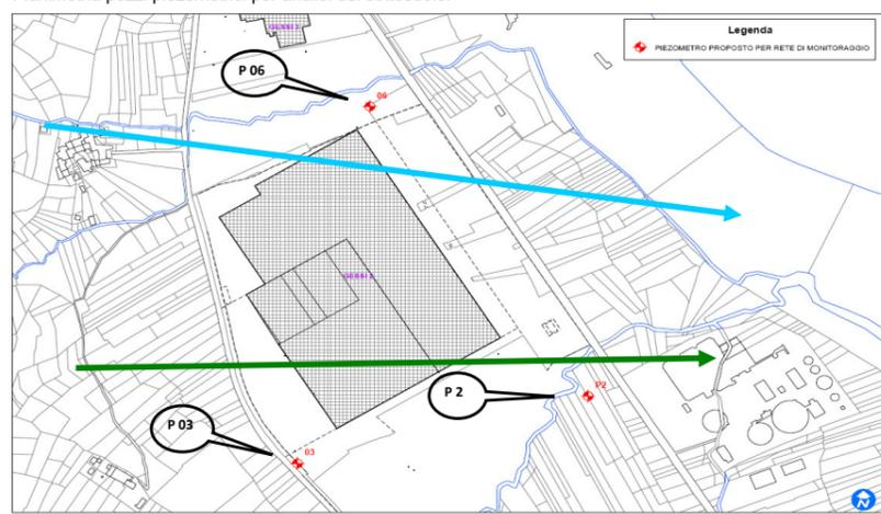
COORDINATE UTM 10256 ALLEGATO 5 - PLANIMETRIA AREA CON UBICAZIONE PIEZOMETRI PROPOSTI SCALE: 1:3.000
